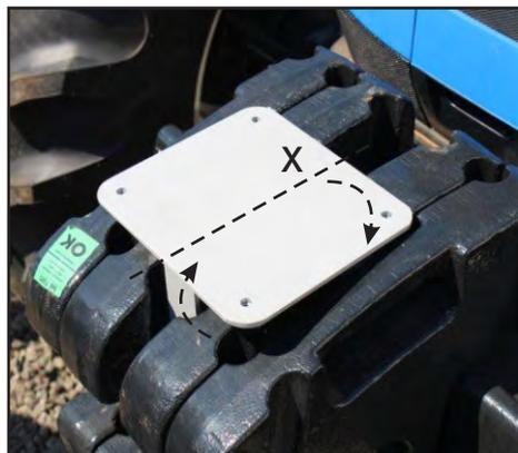
**ETAPA 02** - - Nivele en (x) la Contra Chapa "T" (02), colocando la misma de forma que la columna T se apoye firmemente en los laterales de los contrapesos y que por lo menos un prisionero de su fijación, traspase la columna. Marque este punto y con la ayuda de un taladro, haga un orificio para que sea traspasado por este prisionero. Esto garantizará una fijación bien firme.
