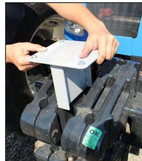
**ETAPA 01:** Para instalar la Sembradora Abonadora (01), coloque la Contra Chapa "T" (02) sobre los contrapesos del tractor.
