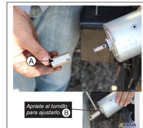
**ETAPA 14** - Encaje el Cubo Auxiliar (A) en el eje del motor, apriete el Tornillo Inferior para fijarlo. Utilice la llave larga Allen 1/8" (B).
