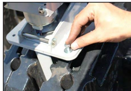
**ETAPA 05** - Fije el MS utilizando cuatro Tornillos Hex. 5/16"x 3/4" (C) seguidos de cuatro Arandelas 5/16" (D).
