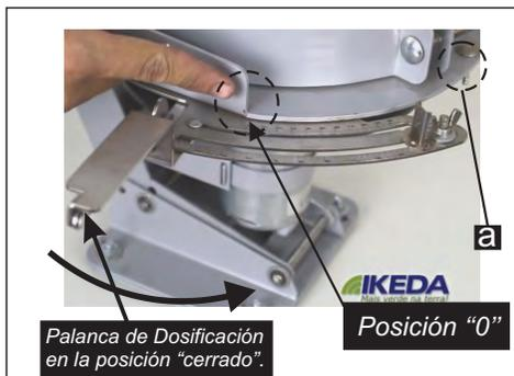
**ETAPA 10** - Afloje la tuerca mariposa (a) para desbloquear el **Registro de Posición**. **Bloquee la Palanca de Dosificación en la posición "cerrado"**. Mueva el **Registro de Posición** completamente hacia la derecha, hasta que su marca llegue a "0" y apriete luego la tuerca mariposa (a) para bloquearlo en la posición.
