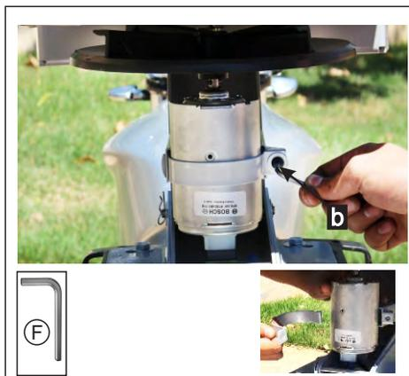
**ETAPA 11** - Retire el Soporte del motor (b) utilizando la llave Allen 3/16" (F).
