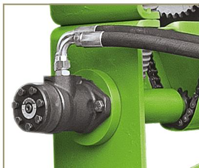
Accionamiento del dosificador de abonos a través de motor hidráulico.
