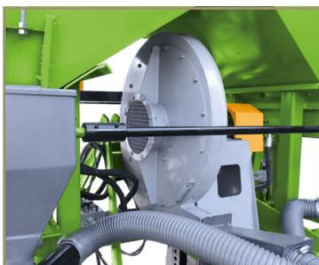
Ventilador Centrifugo de Alta Presión
