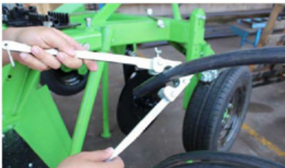
5) Regule la fuerza de prensado de la manguera, en la mariposa. Un prensado muy alto dañará la manguera y otra muy baja, no fija la manguera. Este ajuste es necesario, debido a la variación del diámetro externo de cada marca de la manguera.
