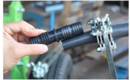
4) Como referencia, la posición del alicate deberá permitir el encaje de la enmienda, con una holgura de 1 a 2 cm.
